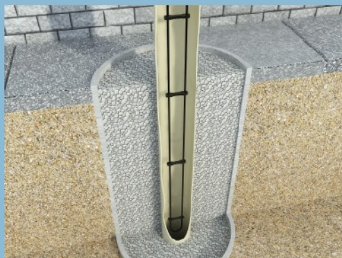
Ułożenie przewodu grzejnego poniżej poziomu terenu
